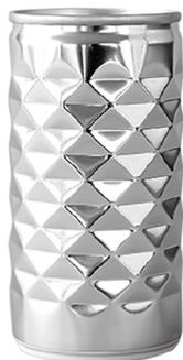
東洋製罐グループの製造するダイヤカット缶は、1969年に三浦公亮・東京大学名誉教授が考案・発表した「PCCP(擬似円筒形凹多面体 Pseudo-Cylindrical Concave Polyhedral) シェル」を参考に開発され、1996年より生産を開始しました。PCCPシェルは、宇宙工学(超音速機の胴体の破壊モデル)の研究過程で、破壊により変形した形状が非常に安定した構造となっていたという発見を基に、考案されたものです。この変形は、「等長変換」と呼ばれ、折り紙のように折っても、素材そのものの
